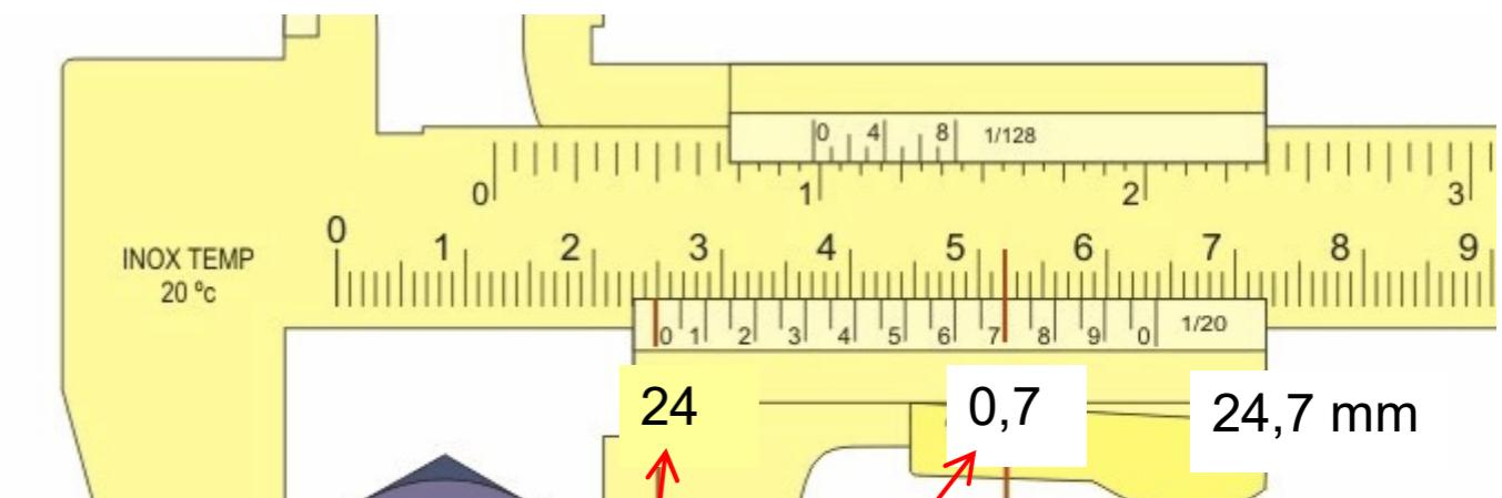
Ici, le zéro du vernier se positionne **au-dessus** de 24mm, légèrement en dessous de 25mm
