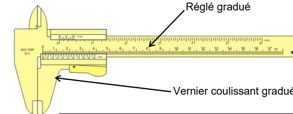
Insérer l'objet à mesurer dans les « mâchoires » en faisant coulisser le vernier.
